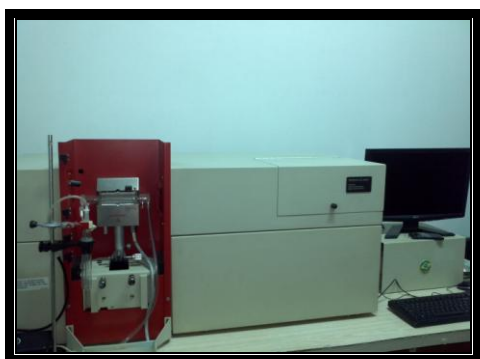
Figura 2. Espectrofotômetro de Absorção Atômica - BIGS acoplado a cela de quartzo fixada a um forno de geração de hidretos utilizado como suporte no caminho óptico.
