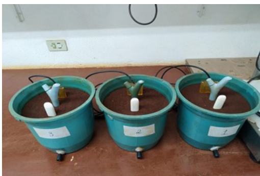
Figura 1. Baldes utilizados na calibração dos sensores de capacitância.
